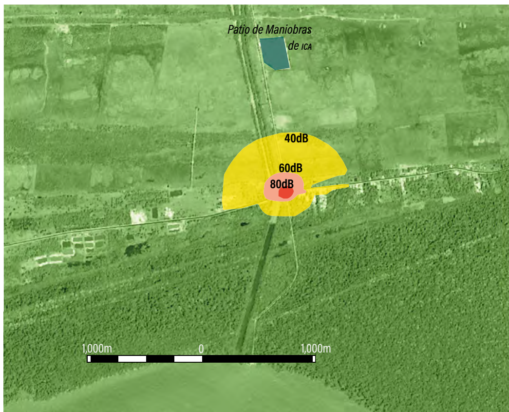
Figura 5. Niveles de ruido provenientes de fuentes móviles, modelado con SPreAD-GIS, en el entronque de la carretera federal 180 con el camino de acceso al patio de maniobras de ICA, el CPTGA y el APA.
