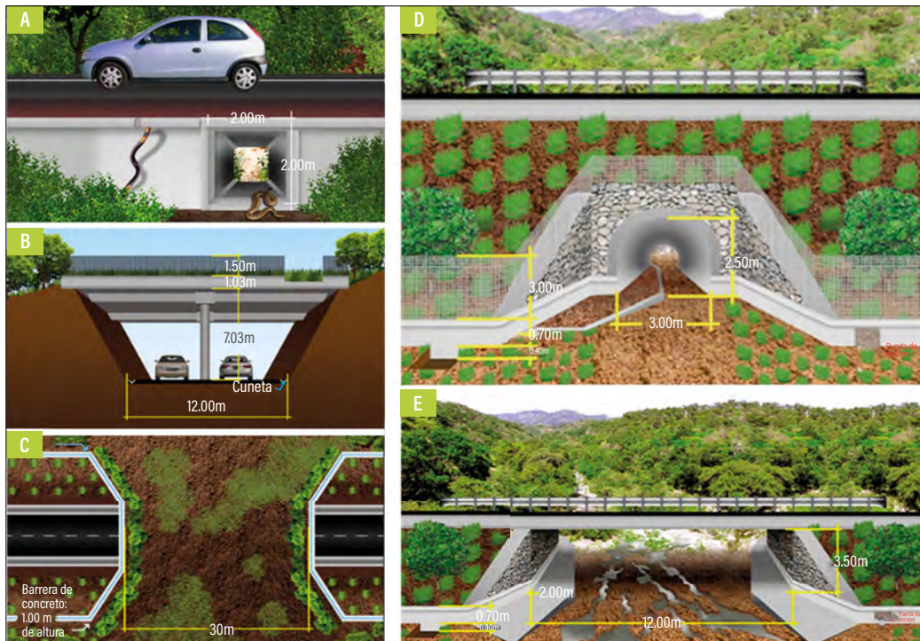
Figura 1. Ejemplos de estructuras que funcionan como pasos de fauna: A) caja de losa, B) paso superior de fauna, C) viaducto, D) paso inferior de fauna, E) puente. (Biología Integral en Impacto Ambiental, S. A. de C. V.)
