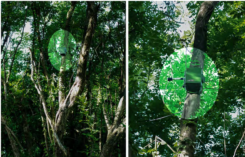
Figura 11. Ubicación de un detector de murciélagos automático SM4BAT (Wildlife Acoustics), para monitorear murciélagos insectívoros mediante el método pasivo. (Fotografía: José D. Cú-Vizcarra.)
