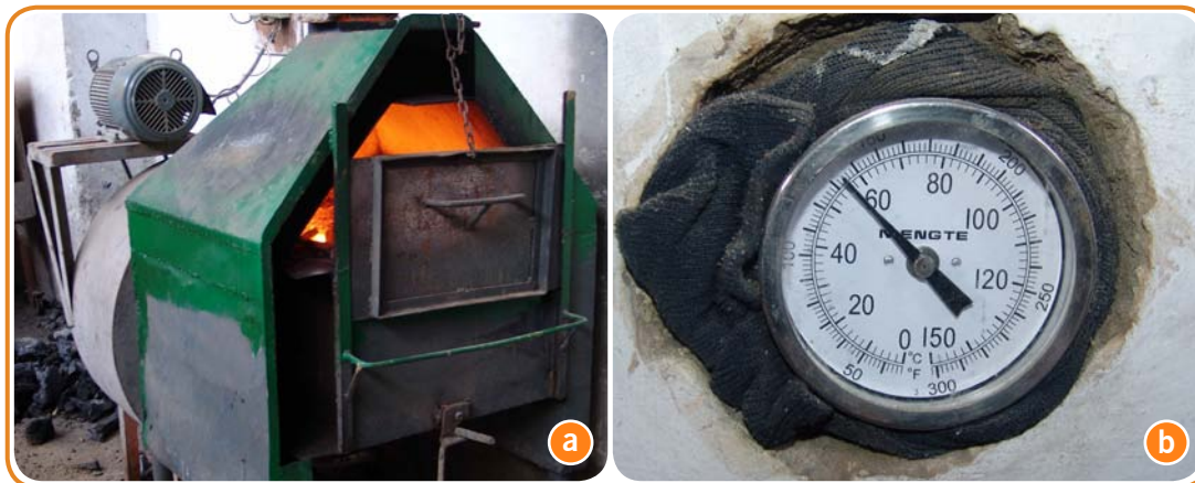
Figura 4. a. Equipo empleado para calentar el aire en secadores de café, utilizando coque como combustible. b. temperatura del aire de secado.
