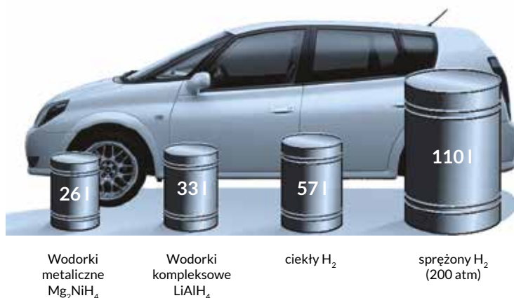
Rys. 2. Wielkość zbiornika magazynującego 4 kg wodoru w różnych technologiach magazynowania (wodór sprężony, wodór ciekły oraz związany w strukturach ciał stałych), pozwalającego na przejazd ok. 400 km
