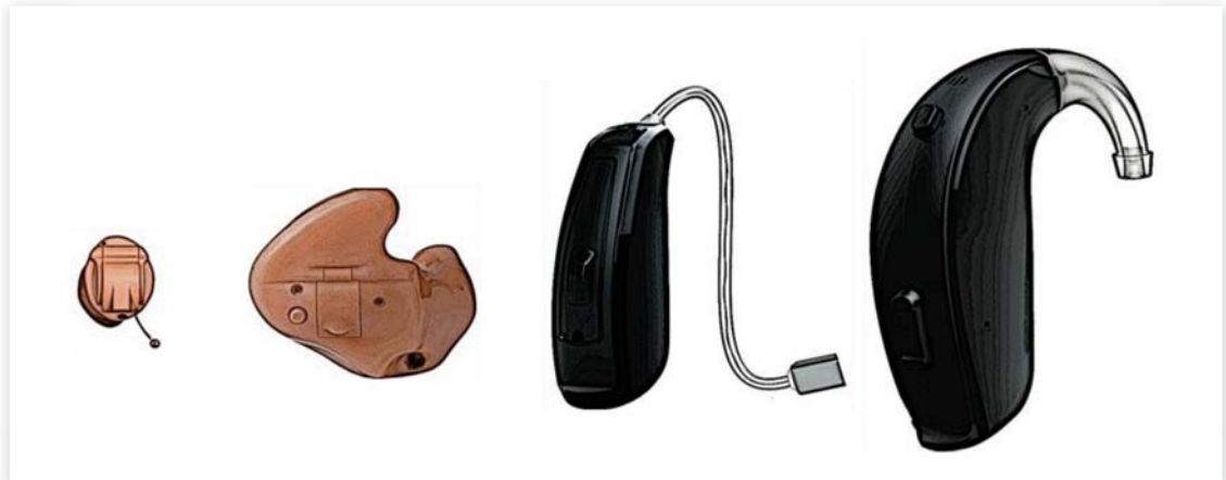
Abbildung 3: Hörgerätebauformen (schematisch), von links nach rechts: Completely in the Canal (CIC), Im-Ohr-Hörgerät (IdO), Receiver in the Canal (RIC) und Hinter-dem-Ohr-Hörgerät (HDO)
