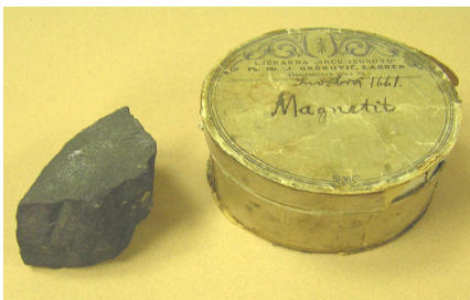
SLIKA 2. Najjači prirodni magnet, mineral magnetit \text{Fe}_3\text{O}_4 . Iz zbirke učila PMF-a u Zagrebu.
