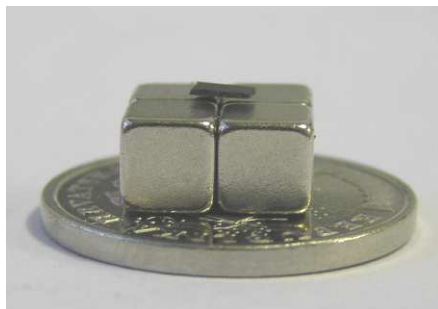
SLIKA 11. Listić grafita lebdi iznad magnetskog kvadropola.
