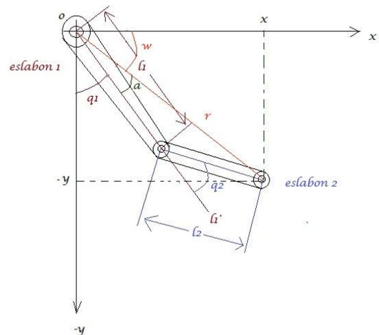
Figura. 1. Diagrama de un manipulador de dos grados de libertad al cual se le aplica la cinemática directa e inversa.
