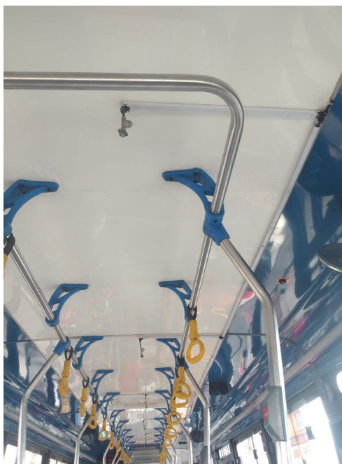
Figura 2 – Aplicación de los sistemas de nebulización en el transporte (Elaboración propia, 2021)
