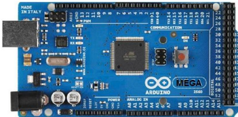
Fig. 2. Arduino mega
