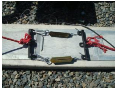
Figura 4 a) Excitación de los equipos no energizados con “jalar y soltar” y “jalón cíclico” y b) dinamómetros empleados para medir la tensión aplicada
