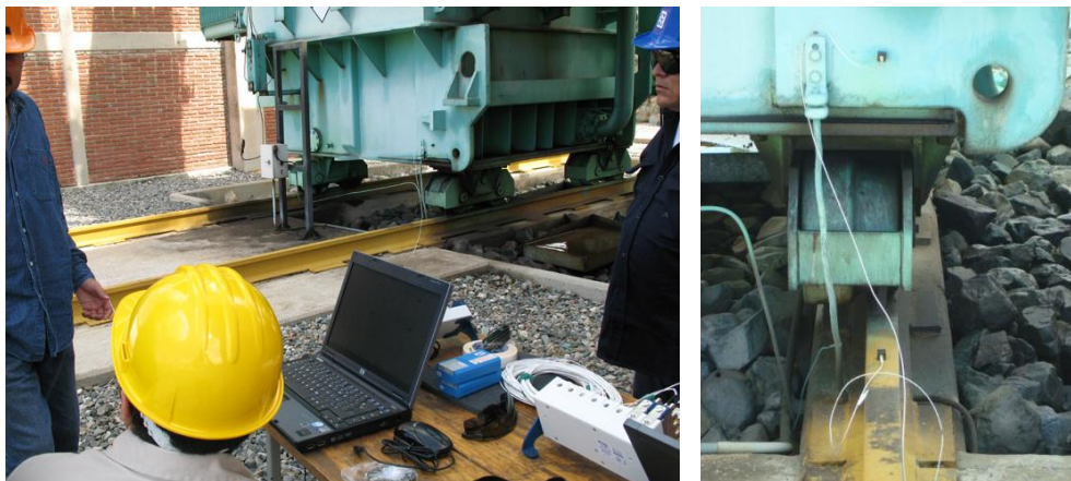
Figura 2 Colocación de acelerómetros en la base y sobre el riel de un Transformador de Potencia
