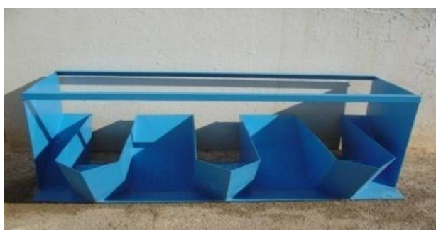
Figure 2. Modèle expérimenté (PK-Weir type A2m)
