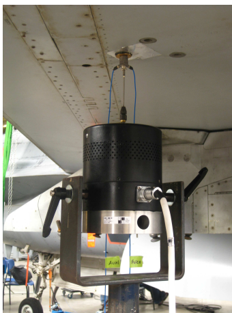
(d) Shaker attached underneath the left wing.
