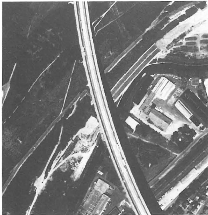
Abb. 6.3: Beispiel für Orthophotoerzeugung mit verfeinerten DGM-Maschen [Lotter 87].
