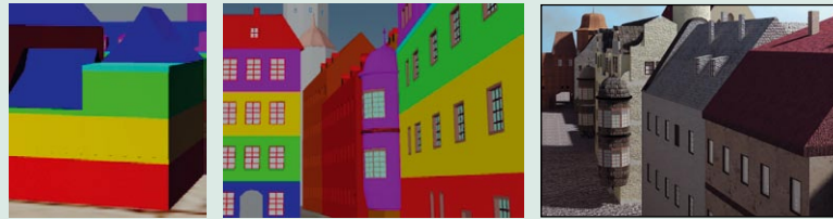
Abb. 2: Abfolge der Modellierung – Grobmodell, Objekt mit Details; Detailmodell mit Oberflächen
