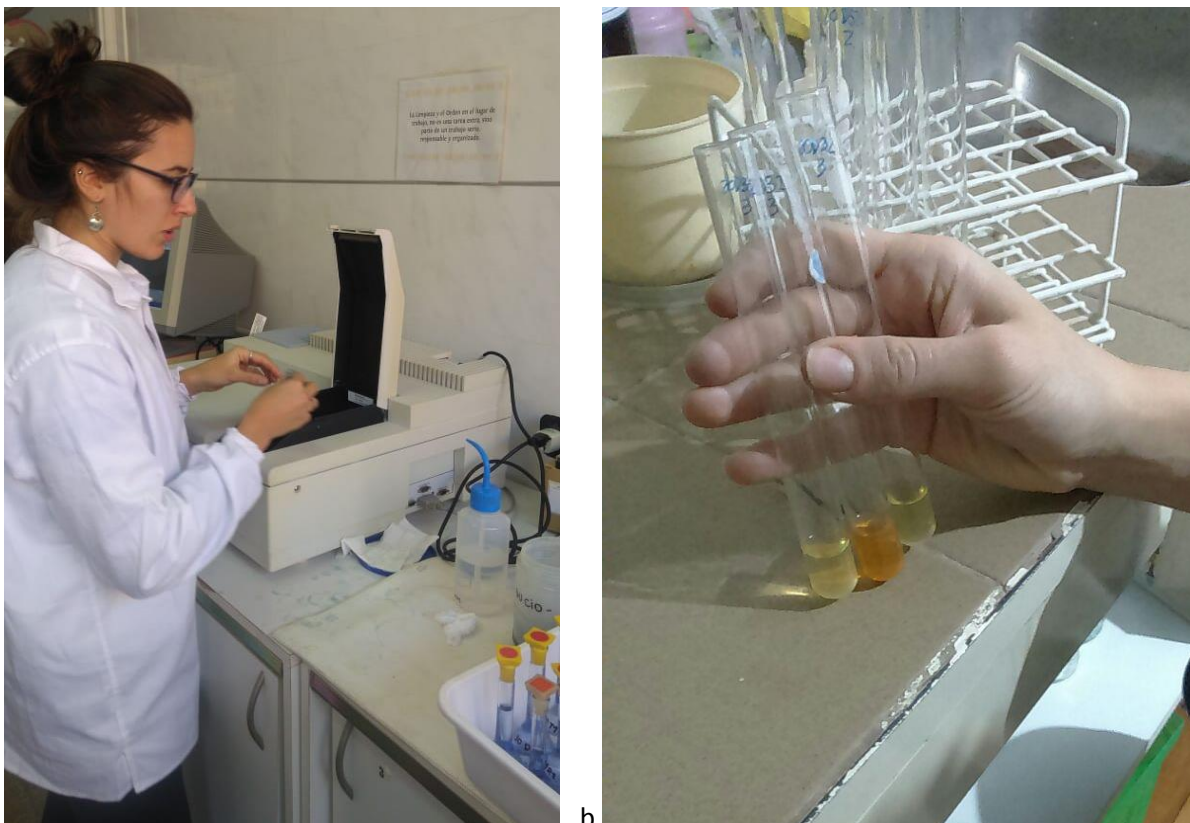
a. b. Figura 2: Determinación de etapa colorimétrica del Fósforo disponible (a); Revelación de microorganismos amonificadores con reactivo Nessler (b).
