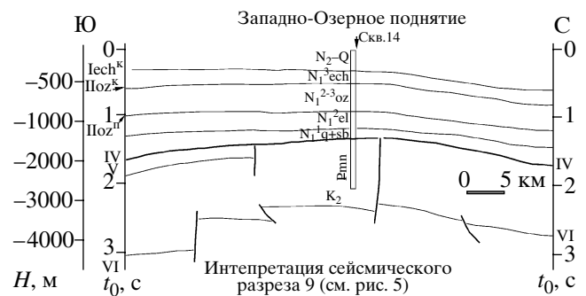
Рис. 6. Геолого-геофизический разрез по субширотному профилю МОГТ через Западно-Озернинское поднятие. Местоположение профиля см на рис. 5. Интерпретация основных отражающих горизонтов: VI – кровля акустического фундамента (омолаживается в северном направлении); V – подошва верхней песчаной подсветы майницкой свиты (олигоцен); IV – подошва гагаринской и собольковской свит (нижний миоцен); П oz п – подошва озернинской свиты (средний миоцен); П oz к – кровля озернинской свиты (верхний миоцен); I ech к – кровля эчинской свиты (плиоцен)
