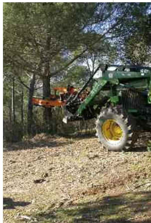
Máquina vibradora incorporada a un tractor de ruedas realizando una demostración de apeo de piña en Cabeza Aguda, diciembre 2005
