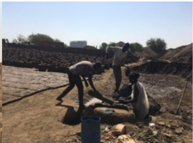
Figure 11 : Ouvriers qui moulent des briques à partir du mélange de limon, d'eau et de zibāla . © CPH. Al Gereif Sharg, 16/2/2020
