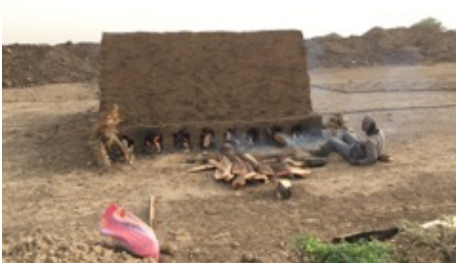
Figure 16 : Un four à briques. Le combustible est placé dans les « yeux » du four. © CPH. Al Gereif Sharg, 19/2/2020
