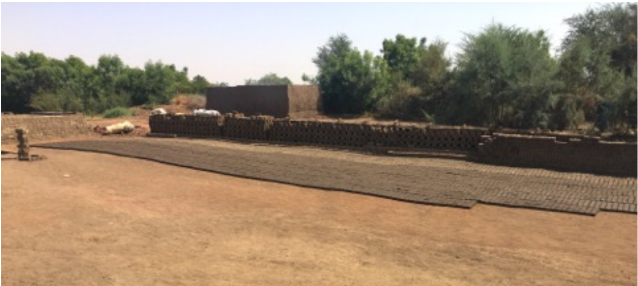
Figure 1 : Les briques crues qui sèchent au soleil sur l'île de Tuti. © CPH, 30 avril 2019
