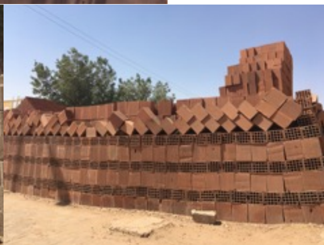
Figure 6 : La ṭoub ḥarārī (brique thermique ou industrielle) © CPH, 13/2/2020
