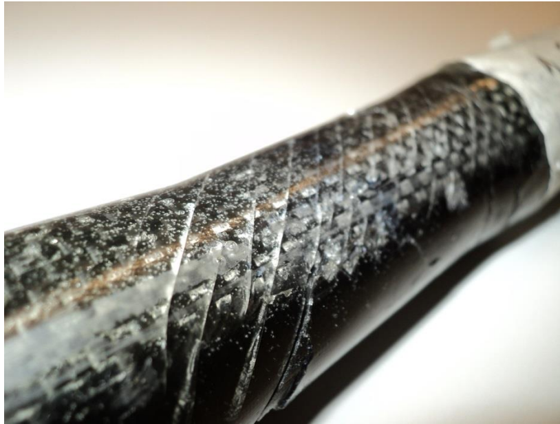
Figura 5.7. Fissuração a 45° visível na resina.
