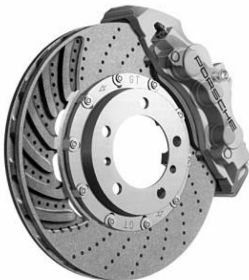
Figura 2.7. Porche Ceramic Carbon Brake – Disco de travão desenvolvido pela Porche de matriz cerâmica e fibra de carbono siliconizada. Capaz de suportar temperaturas extremas, 50% mais leve que os discos convencionais, permitiu uma significativa redução na formação de pó, um aumento dos intervalos de manutenção e uma maior durabilidade, especialmente em ambientes corrosivos e em condições extremas, nomeadamente em desportos de alta competição.
