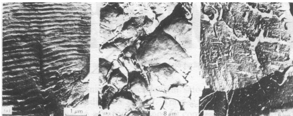
Figura 3.4. Superfícies de fractura de diferentes aços; à esquerda, estriação dúctil, ao centro, coalescência de microcavidades, à direita, microclivagem.
