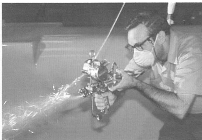
Figura 2.31. Operário a operar uma pistola de projecção.
