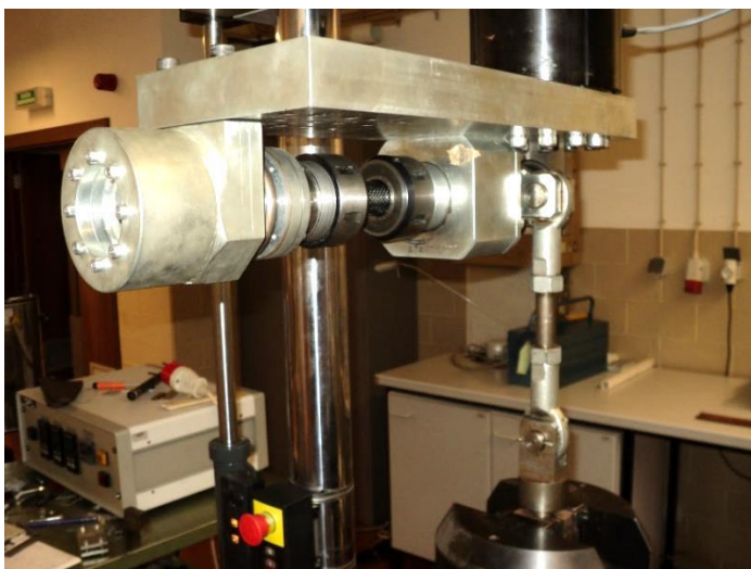
Figuras 4.6 e 4.7. Sistema de fixação dos provetes utilizado nos ensaios de torção pura (esquerda) e esquematização das forças actuantes no sistema (direita), respectivamente.
