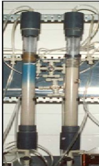
Figura 6.2. Columnas de intercambio iónico Para trabajo en el laboratorio
