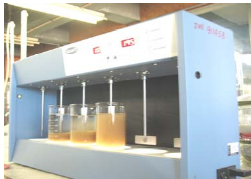
Figura 4.10 Foto de equipo de prueba de jarras
