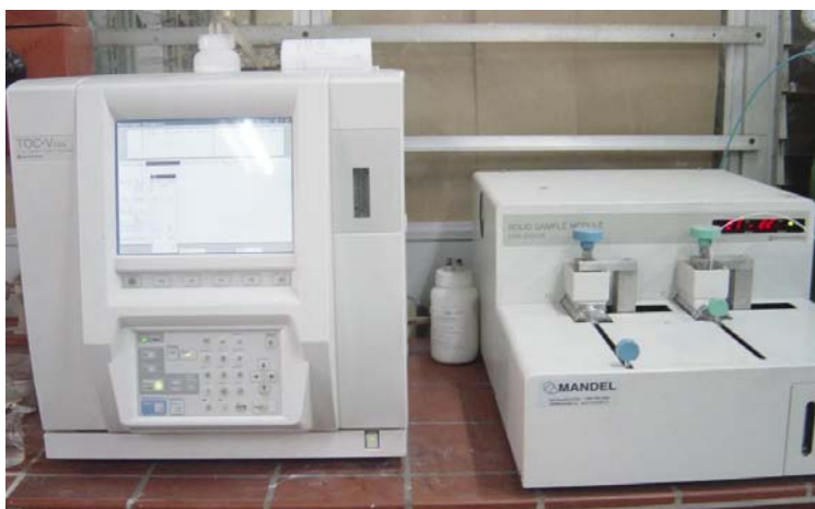
Figura 7.10 Equipo para determinar COT. Líquidos y sólidos
