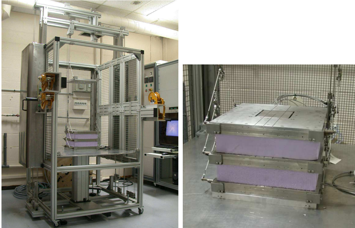
Figure 35 - Vue d'ensemble de l'installation de plaque chaude gardée « haute température »
