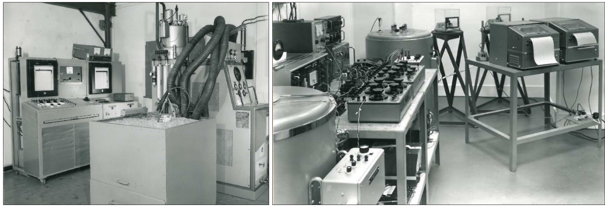
Figure 14 - Plaque chaude gardée (1962) et microcalorimètre (1964) du LNE
