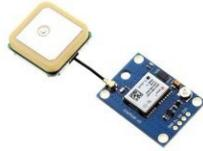
FIGURE 4. Neo-6m GPS module
