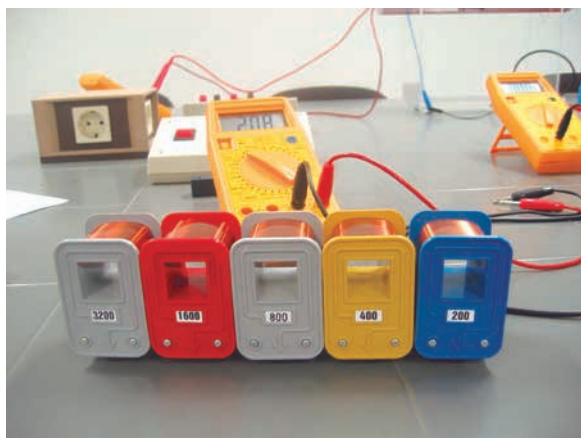
Fig.1. Diferentes bobinas que han sido utilizadas en este trabajo. Los números que llevan impresos nos indican las espiras que tiene cada una.
