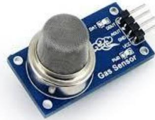
Fig6:MQ 2 Gas sensor IC
