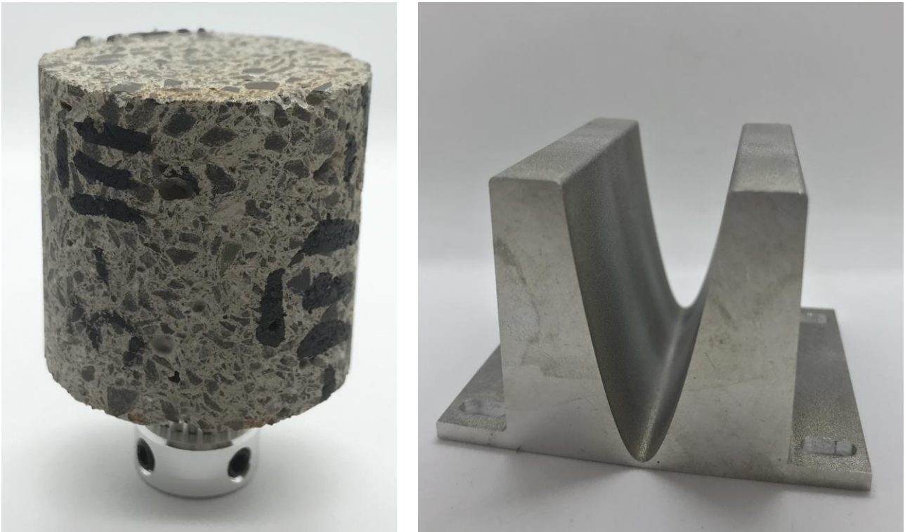
Рис.1. Цилиндрический керн диаметром 38 мм (слева), компенсирующий алюминиевый фильтр (справа)
