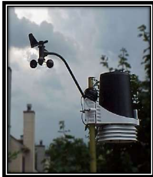
الشكل (1) محطة الأرصاد الأتوماتيكية، وهي من نوع Davis Vantage Pro(2) لقياس العناصر الجوية
