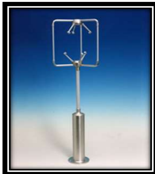
الشكل(2) جهاز قياس سرعة الرياح ذو الاستجابة السريعة fast response – anemometer وهو من نوع Wind master pro,Ultrasonic anemometer -UMG07914-1189-PK-021
