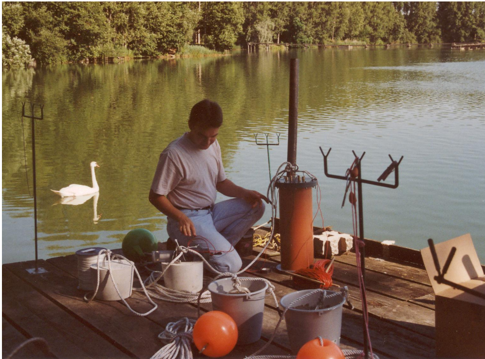
Abbildung 2: Vorbereitung einer Geolore-Seemessung am Ufer: Elektroden und Datenlogger werden an Gewichten (mit Beton gefüllte Eimer) befestigt. Von den Gewichten führen Seile zu den Bojen (Netzschwimmer). Eine der Elektroden wird gerade an einem Gewicht angebracht.
