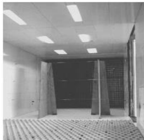
Figura 1.6. Simuladores de Standem (túnel de viento Prof. Jacek P. Gorecki) (Loredo-Souza et al., 2004)
