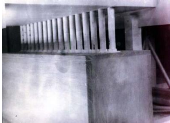
Figura 1.4. Dispositivo emisor de chorros de aire del túnel Prof. Joaquim Blessmann (Loredo-Souza et al., 2004)
