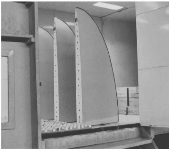
Figura 1.5. Simuladores de Counihan (túnel de viento Prof. Jacek P. Gorecki) (Loredo-Souza et al., 2004)
