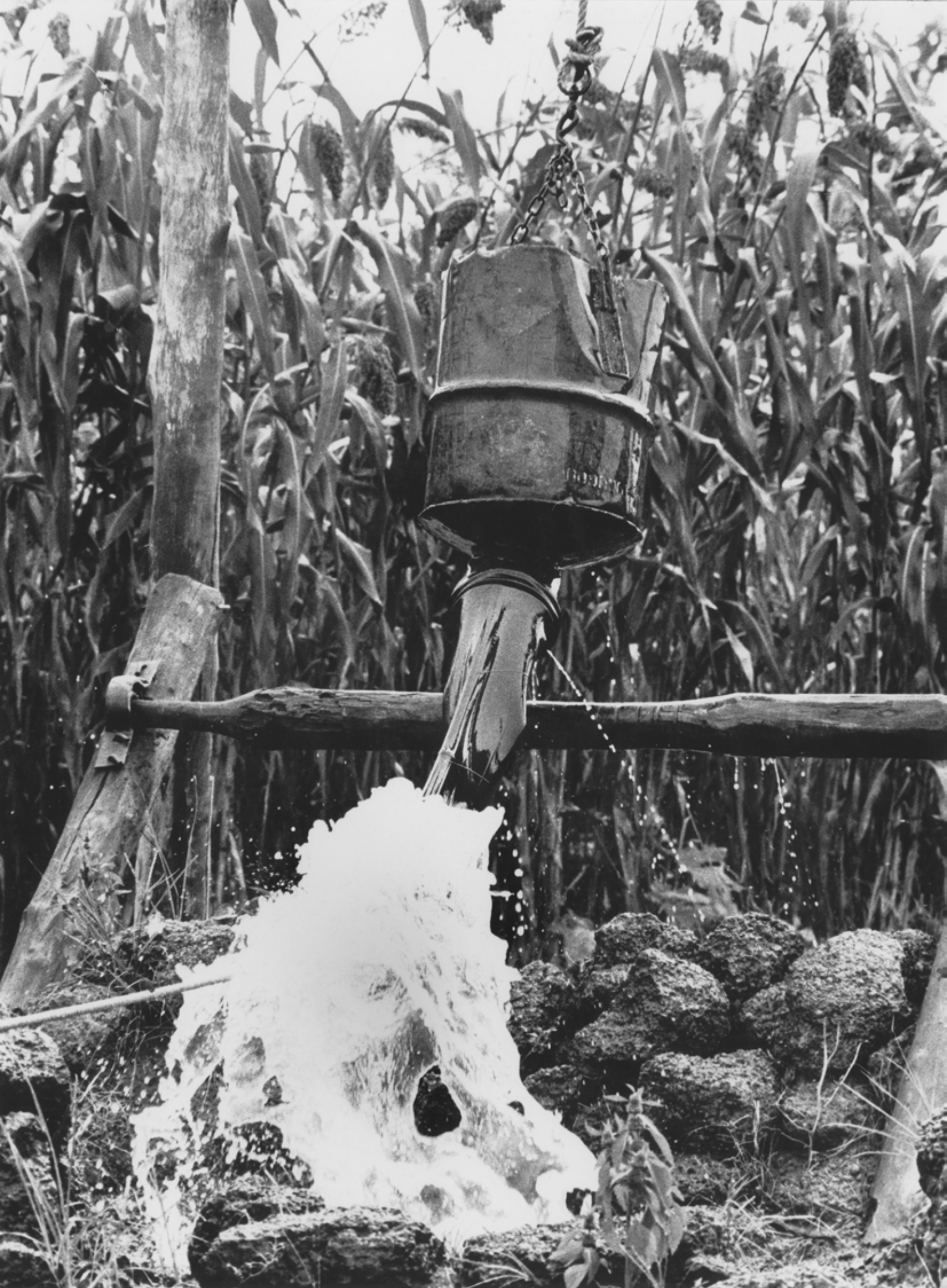
Délu à déversement automatique - Ce dispositif, associé à la traction animale, se rencontre fréquemment dans les jardins de l'Aïr au Niger. Les débits peuvent être importants - 1977.
