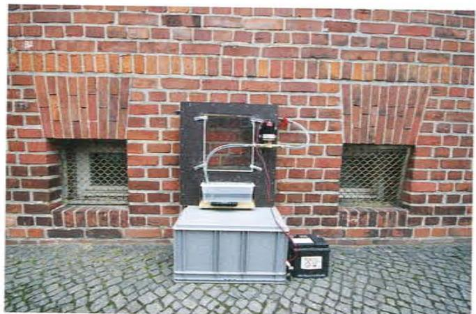
**Bild 3.** Wasseraufnahmemessgerät – Prototyp
