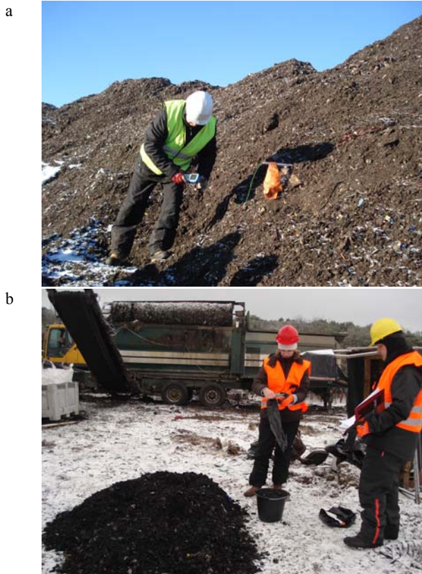
1. attēls. Augsnes (grunts) paraugu ievākšana un analīze Kudjapes izgāztuvē: a) smalkās frakcijas fizikāli ķīmisko parametru noteikšana in situ ; b) materiāla šķirošanas iekārta, kur frakcija <40 mm tiek atdalīta vēlākai sietu un manuālai šķirošanai analītiskajai izpētei (foto: J. Burlakovs).
