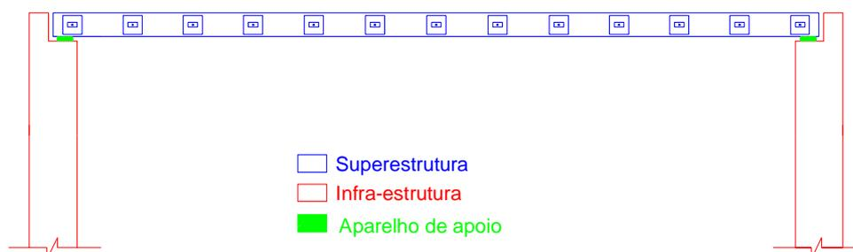
Figura 1 – Partes principais das pontes de madeira laminada protendida.
