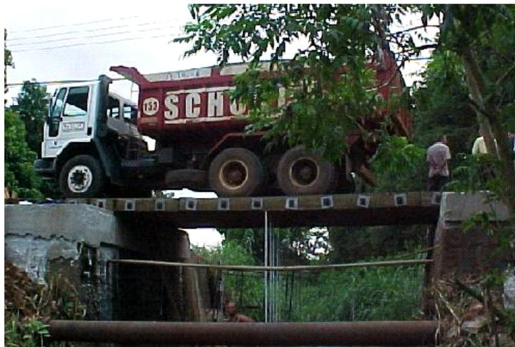
Figura 19 – Veículo posicionado na ponte, para prova de carga.
