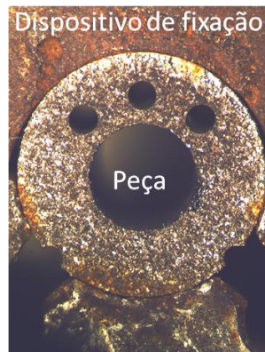
Figura 7 – Peça padrão em Nitinol.
